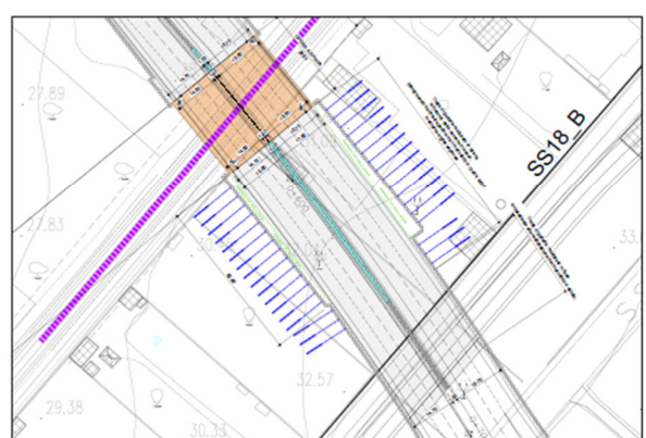
FASE 4 - Infissione monolite e demolizione rostro SCALA 1:500
