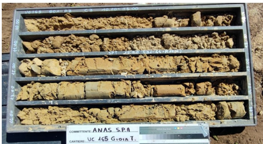
Figura 9: Foto di una cassetta catalogatrice proveniente dal sondaggio S1 (unità G1 da 5 a 9.5 m).
