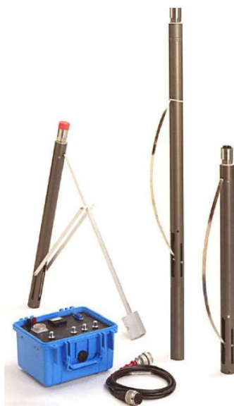
Figura 13: Geofono da foro triassiale "BHGC".
