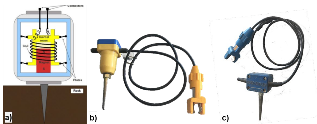
Figura 10 – Geofoni per onda P ed Sh; a) schema di funzionamento del geofono per onda P; b) geofono per onda P con frequenza caratteristica di 4.5 Hz; c) geofono per onda S con frequenza caratteristica di 8 Hz (utilizzato esclusivamente per la sismica a rifrazione).
