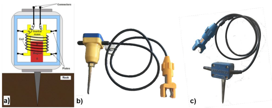
Figura 10 – Geofoni per onda P ed Sh; a) schema di funzionamento del geofono per onda P; b) geofono per onda P con frequenza caratteristica di 4.5 Hz; c) geofono per onda S con frequenza caratteristica di 8 Hz (utilizzato esclusivamente per la sismica a rifrazione).
