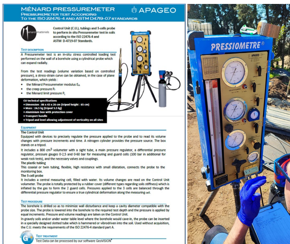
Figura 4: Caratteristiche Pressiometro Menard.
