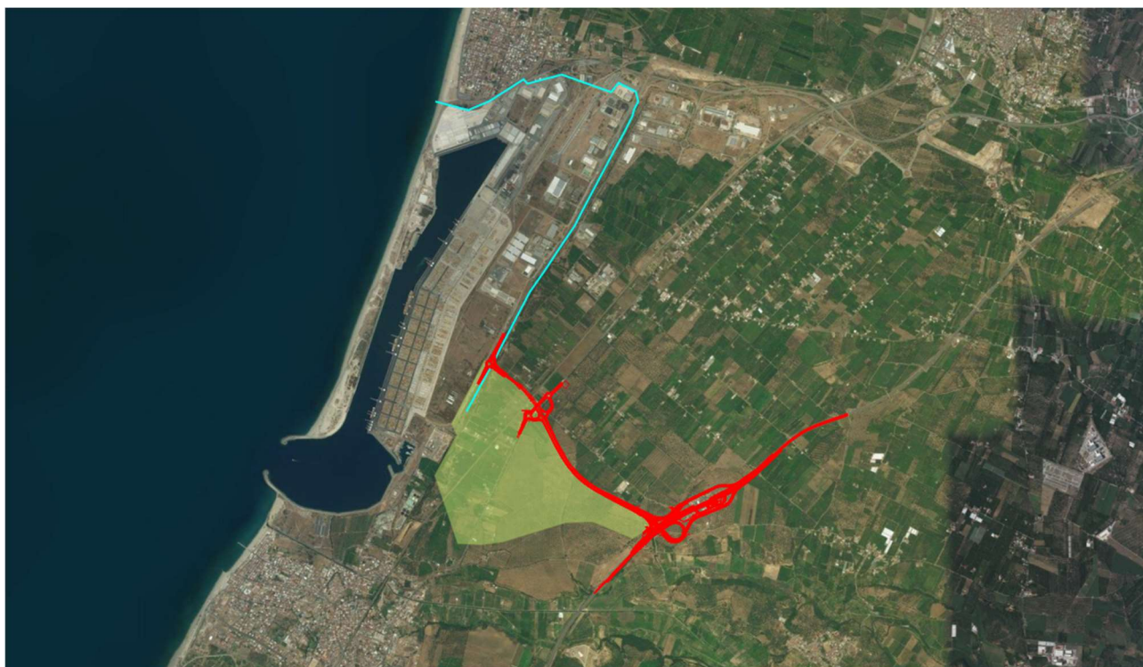
Figura 11 – Interferenza tracciato con il Canale IV
