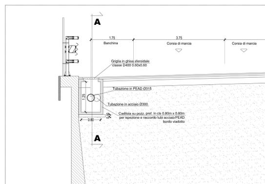
**PARTICOLARE PLUVIALE DA CORDOLO VIADOTTO**
