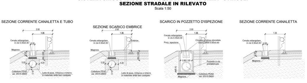
**CADITOIA/POZZETTO ISPEZIONE PREFABBRICATO IN CLS RETE DI DRENAGGIO STRADALE**
