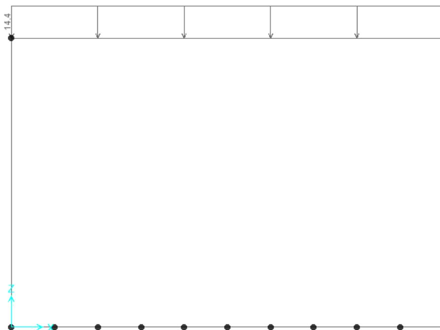
Figura 7 – carico ballast su soletta superiore
