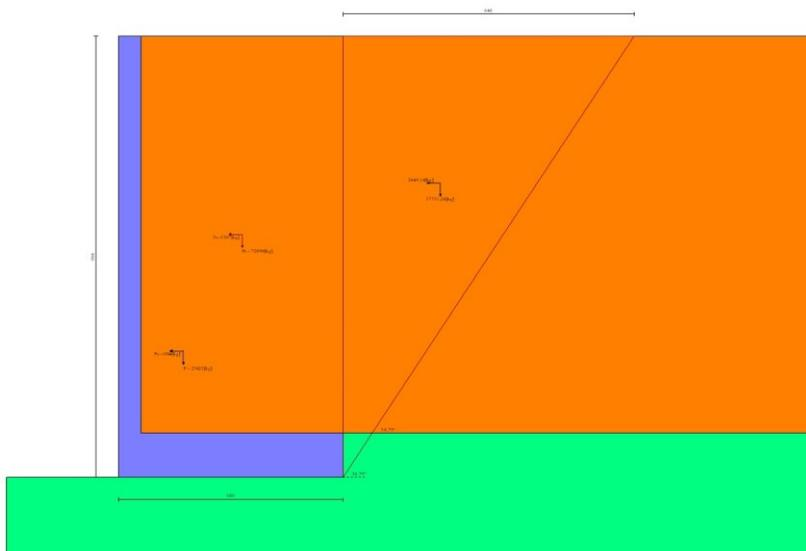
Fig. 5 - Cuneo di spinta (combinazione sismica) (Combinazione n° 1)
