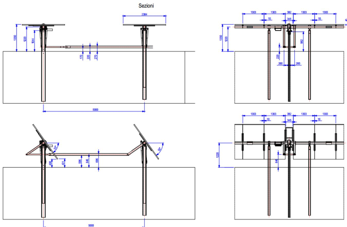
Figura 2: Schema della struttura sezione longitudinale e distanza tra le strutture per agrovoltaico
