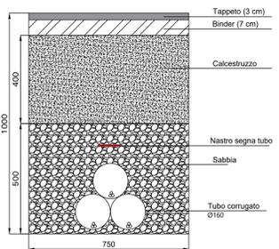
**SEZIONE TIPO CAVIDOTTO SU TERRA**
