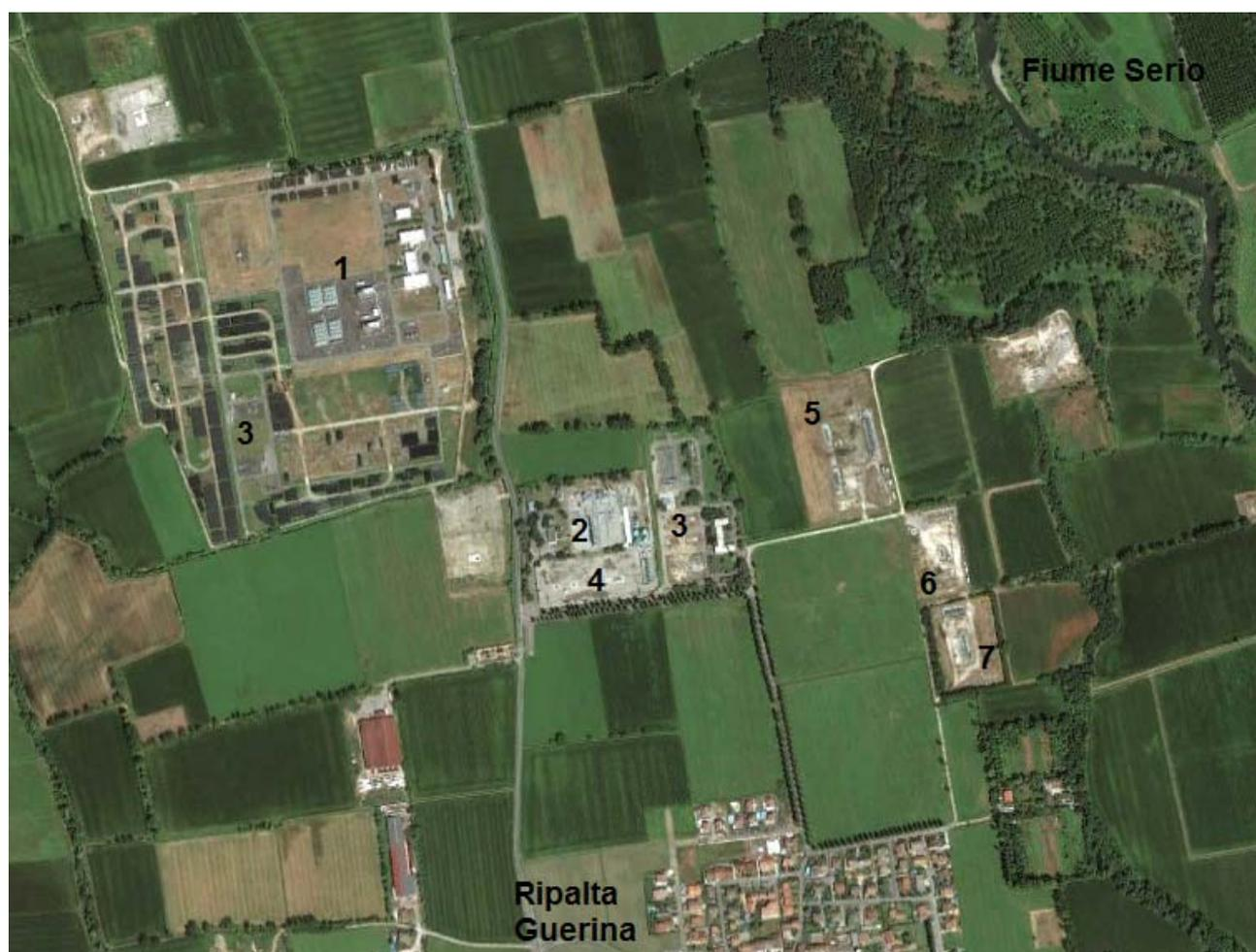
**Fig. 1.1.a – Principali infrastrutture della Concessione Ripalta Stoccaggio – situazione impiantistica attuale (base: Google Earth): (1) impianto (area) di compressione; (2) attuale impianto (area) di trattamento; (3) aree Snam Rete Gas; (4) cluster A; (5) cluster C; (6) cluster B; (7) cluster D**
