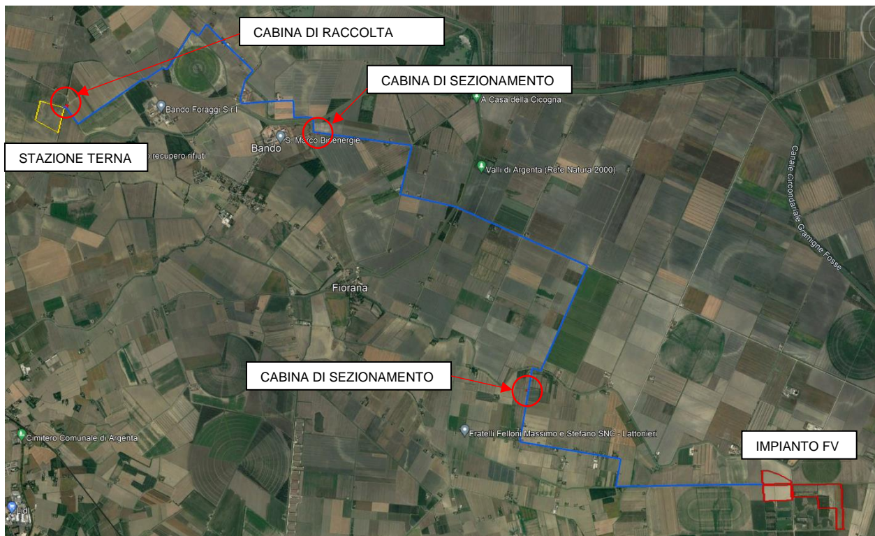
FIGURA 11: INQUADRAMENTO CABINE DI RACCOLTA E SEZIONAMENTO
