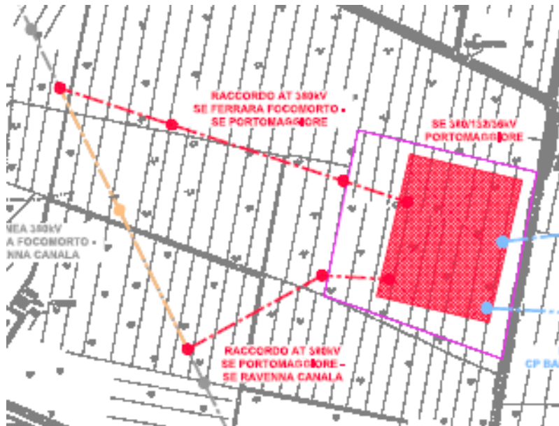
Raccordi con la linea 380 Kv
