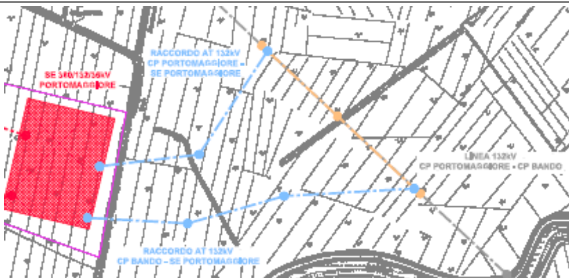
Raccordi con la linea 132 kV
