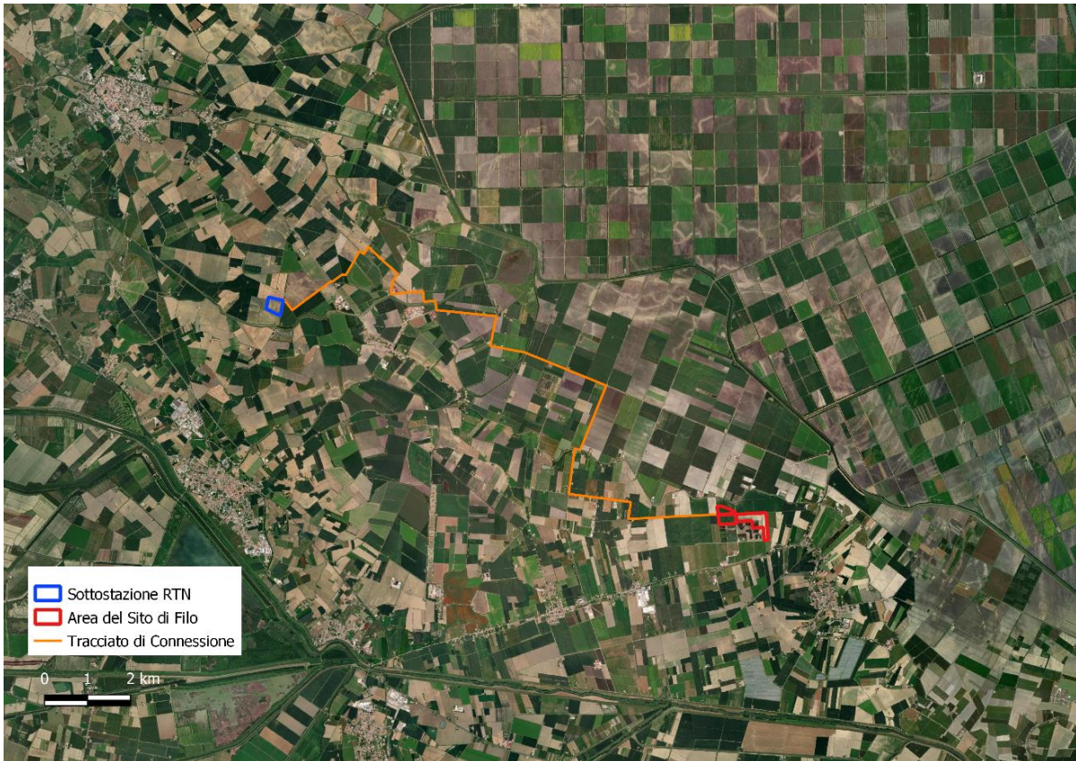
Figura 4- Inquadramento delle opere di progetto: l'impianto fotovoltaico in località Filo(rosso), il cavidotto (giallo) e la sottostazione RTN (blu)
