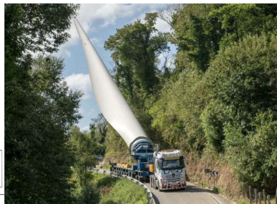
Figura 23 - Caratteristiche dimensionali dei mezzi di trasporto con trasbordo dei pezzi dell'aerogeneratore per la viabilità interna con blade lifter.
