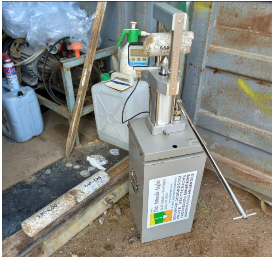
Foto 1 - Esecuzione delle prove Point load
