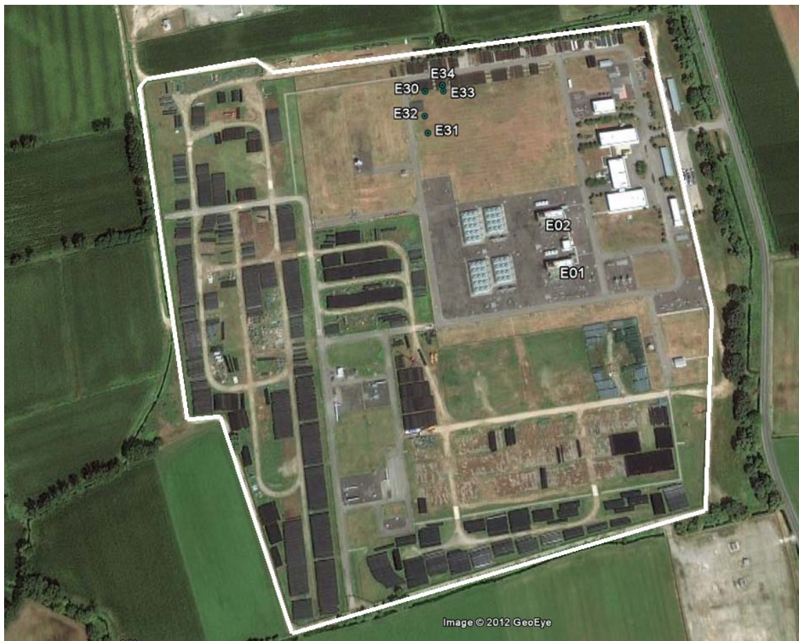
Figura 3.5.c – Centrale Stogit di Ripalta, configurazione operativa dall'anno 2016: ubicazione ricostruita dei punti di emissione considerati: E01-E02 compressione; E30÷E34 trattamento
