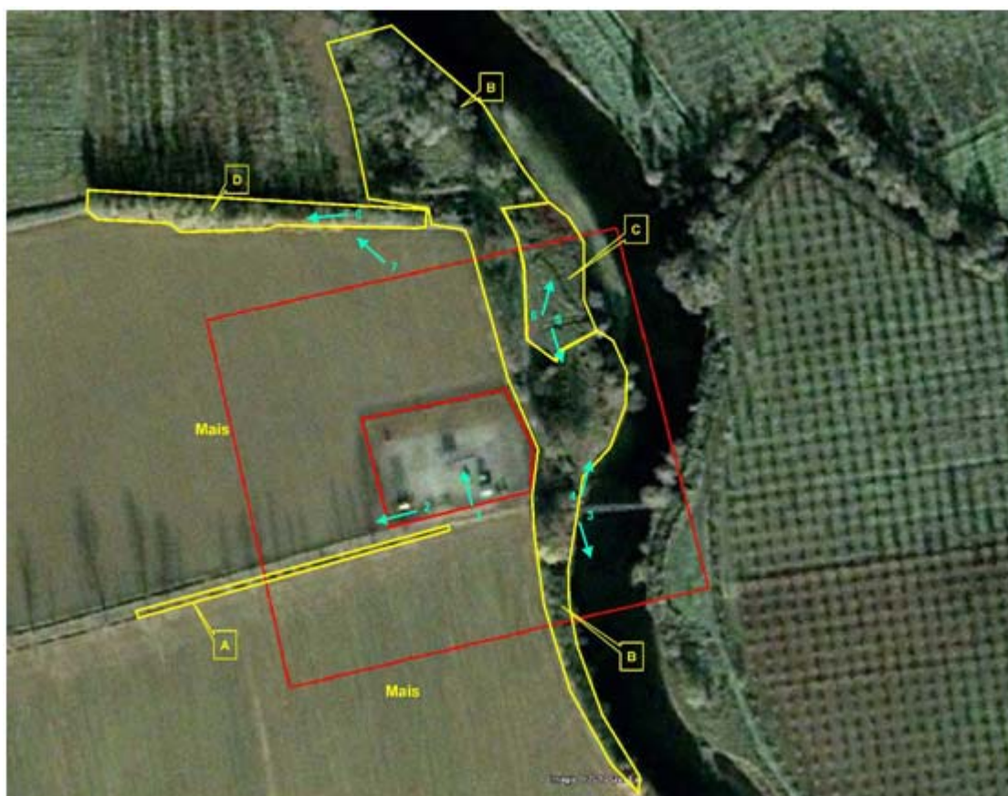
Figura 6.3.s – Pozzo Ripalta 10: inquadramento ambientale, A-D settori analizzati con evidenziati i punti di ripresa fotografica
