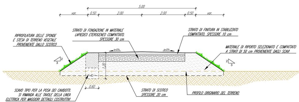
SEZIONE TIPO DELLA NUOVA VIABILITA' IN PROGETTO IN RILEVATO
