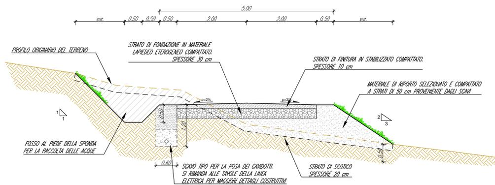
SEZIONE TIPO DELLA NUOVA VIABILITA' IN PROGETTO A MEZZA COSTA
