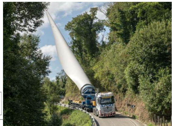
Figura 40 - Caratteristiche dimensionali dei mezzi di trasporto con trasbordo dei pezzi dell'aerogeneratore per la viabilità interna con blade lifter
