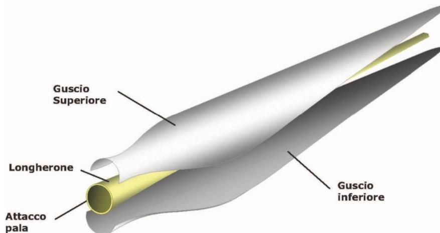
**Figura 1 - Schema strutturale di una pala eolica.**
