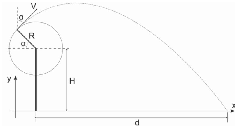
**Figura 3 – Schema della traiettoria della pala in caduta.**
