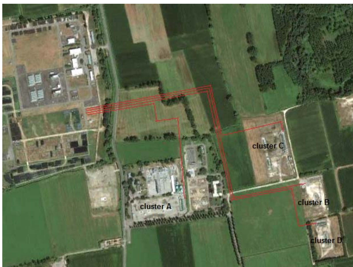
Figura 3.1.h – Tracciato indicativo delle nuove condotte di collegamento cluster-nuova centrale di trattamento (base Google)
