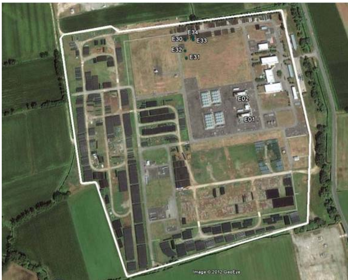
Figura 3.2.c – Centrale Ripalta: ubicazione punti di emissione in atmosfera: condizione impiantistica futura operativa dall’anno 2016.
