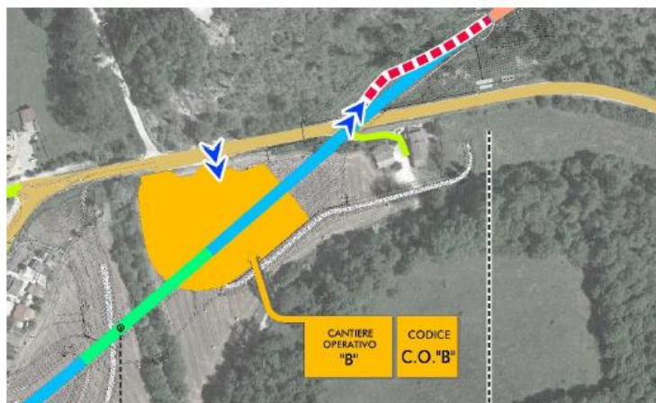
Figura 4 Planimetria con indicazioni della pista di cantiere per il collegamento dell'area di lavoro presso l'imbocco Ovest della Galleria Pietralunga 1 (Estratto dall'elaborato T00CA01CANPL01A)
