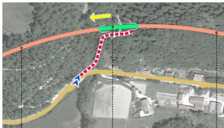
Figura 4 Planimetria con indicazioni della pista di cantiere per il collegamento dell'area di lavoro presso l'imbocco Ovest della Galleria Pietralunga 1 (Estratto dall'elaborato T00CA01CANPL01A)
