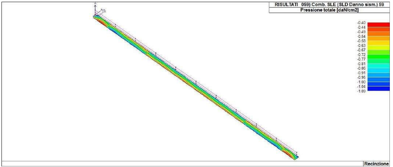
46_RIS_PRESSIONI_059_Comb. SLE (SLD Danno sism.) 59
