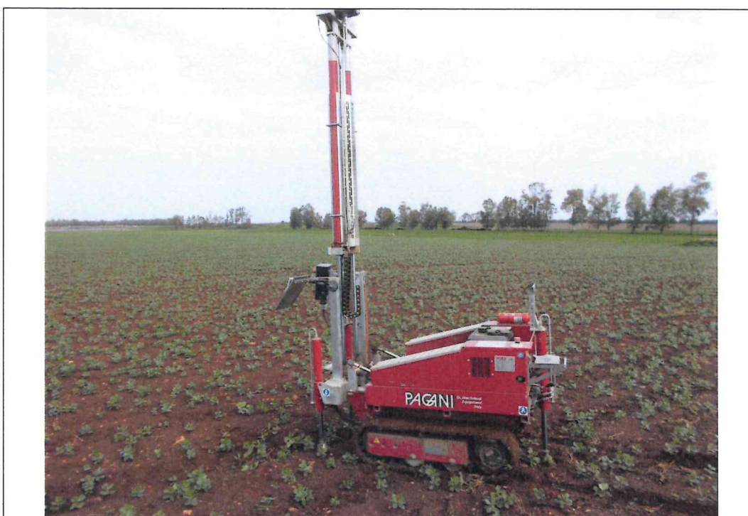
Esecuzione prova DPSH 4
