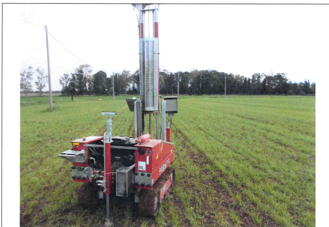
Esecuzione prova DPSH 3
