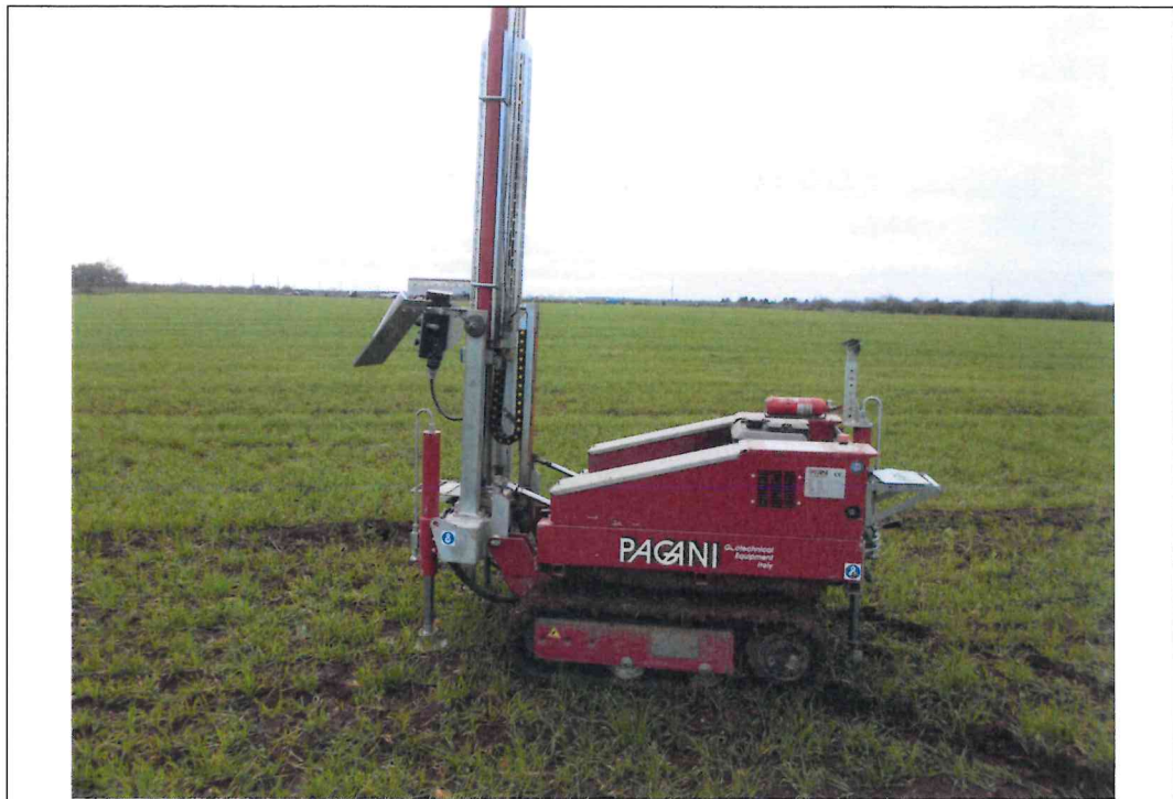
Esecuzione prova DPSH 1
