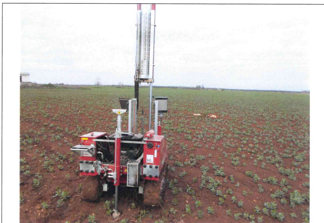
Esecuzione prova DPH 5
