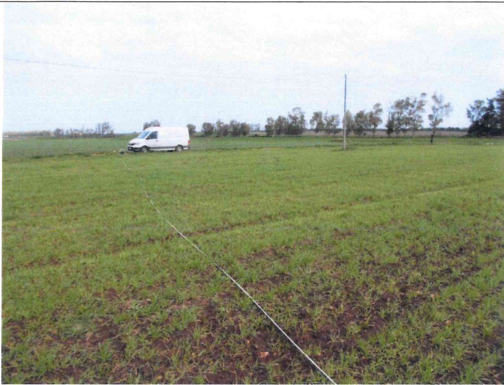
Esecuzione profilo Masw 1 – Area impianto agrovoltaico
