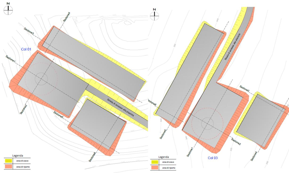
Figura 4- Esempio di progettazione della piazzola in diverse aree funzionali per minimizzare i movimenti di terra
