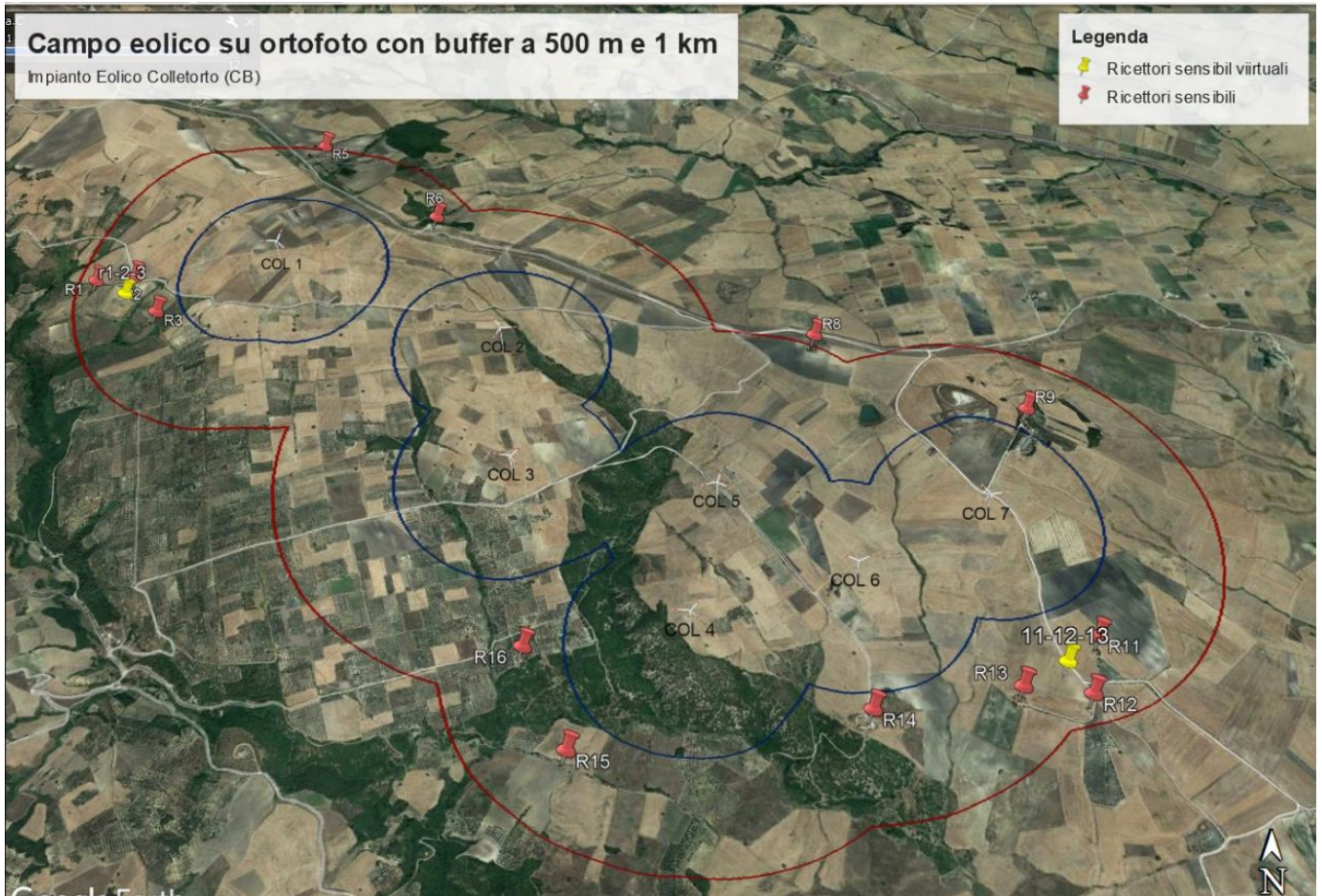
Figura 6: Layout impianto su ortofoto con areale (in rosso i buffer di 1.000 m) attorno ai n° 7 aerogeneratori di progetto.
