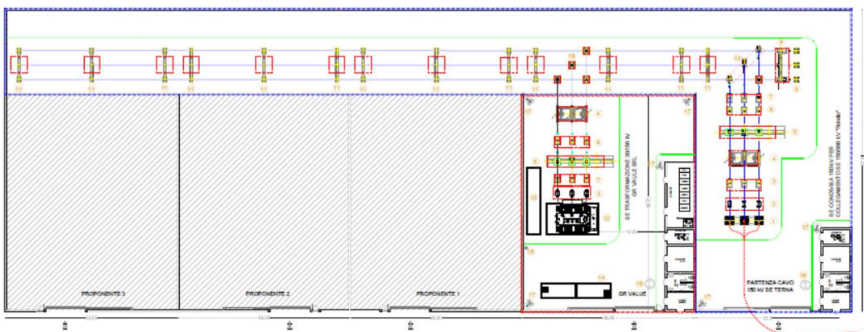
Figura 18: Stralcio della planimetria della SE condivisa (forma ad L con perimetrazione blu) – Nel Rettangolo Rosso è indicata la SE di trasformazione 30/150kV di GRValue. Gli altri rettangoli rappresentano le aree per altri produttori che condividono lo Stallo AT con GR Value.
