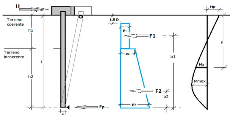
Una volta note tutte le forze in gioco, si determina il diagramma del momento lungo il fusto del palo.
