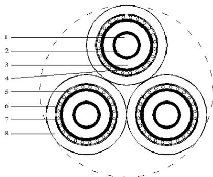
La sezione dei cavi di ciascun tronco di linea è stata determinata in modo da minimizzare le perdite di potenza per effetto joule ed essere adeguata ai carichi da trasportare nelle condizioni di massima produzione di tutti gli Aerogeneratori, ossia alla potenza massima di 39,2 MW.
