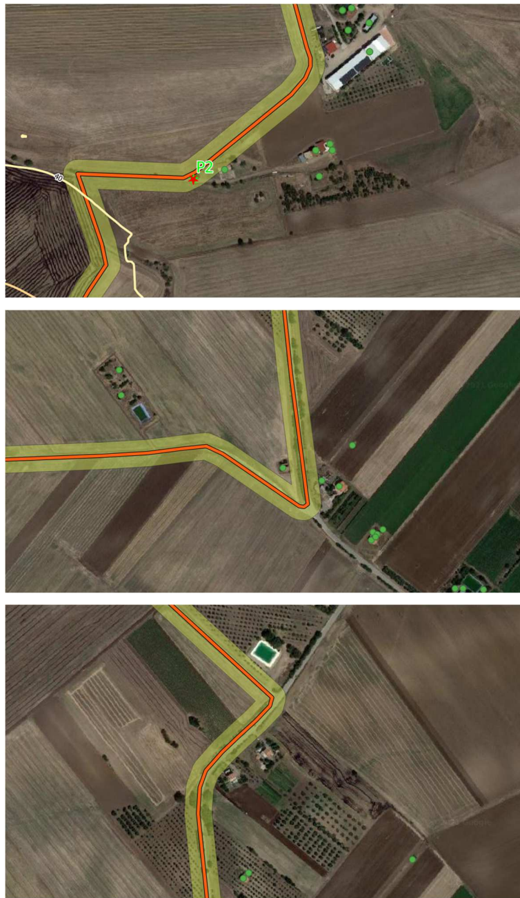
Figura 4 – Recettori ubicati lungo il tracciato del cavidotto potenzialmente disturbati dalle attività di cantiere
