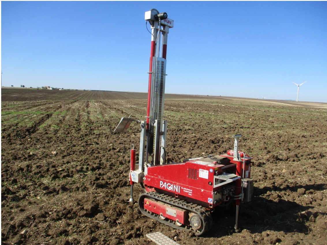
Esecuzione prova dpsh
