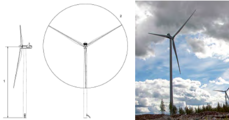
Figura 36: Caratteristiche dimensionali e compositive di un aerogeneratore tipo
