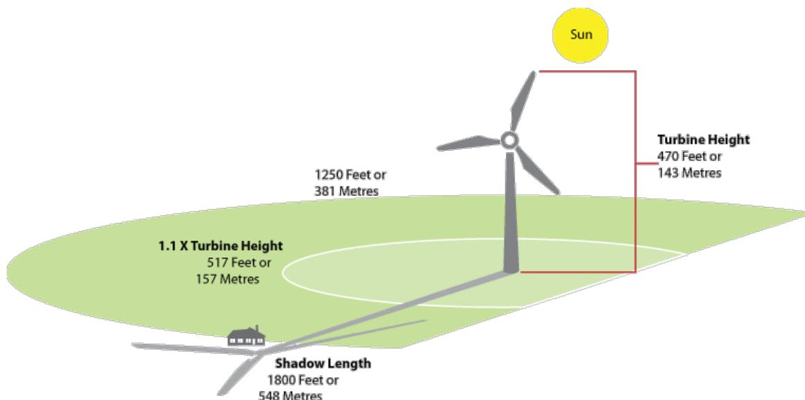
Figura 1: rappresentazione schematica del fenomeno dello shadow flicker
