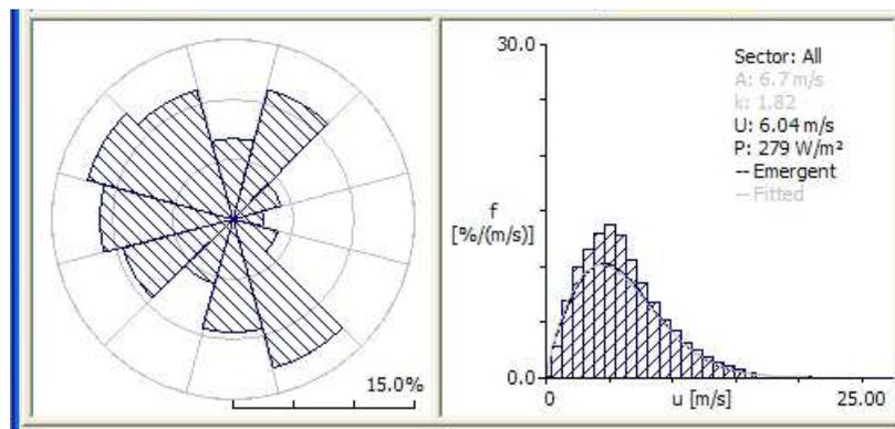
Figura 2: frequenza della direzione del vento per la torre anemometrica di riferimento
