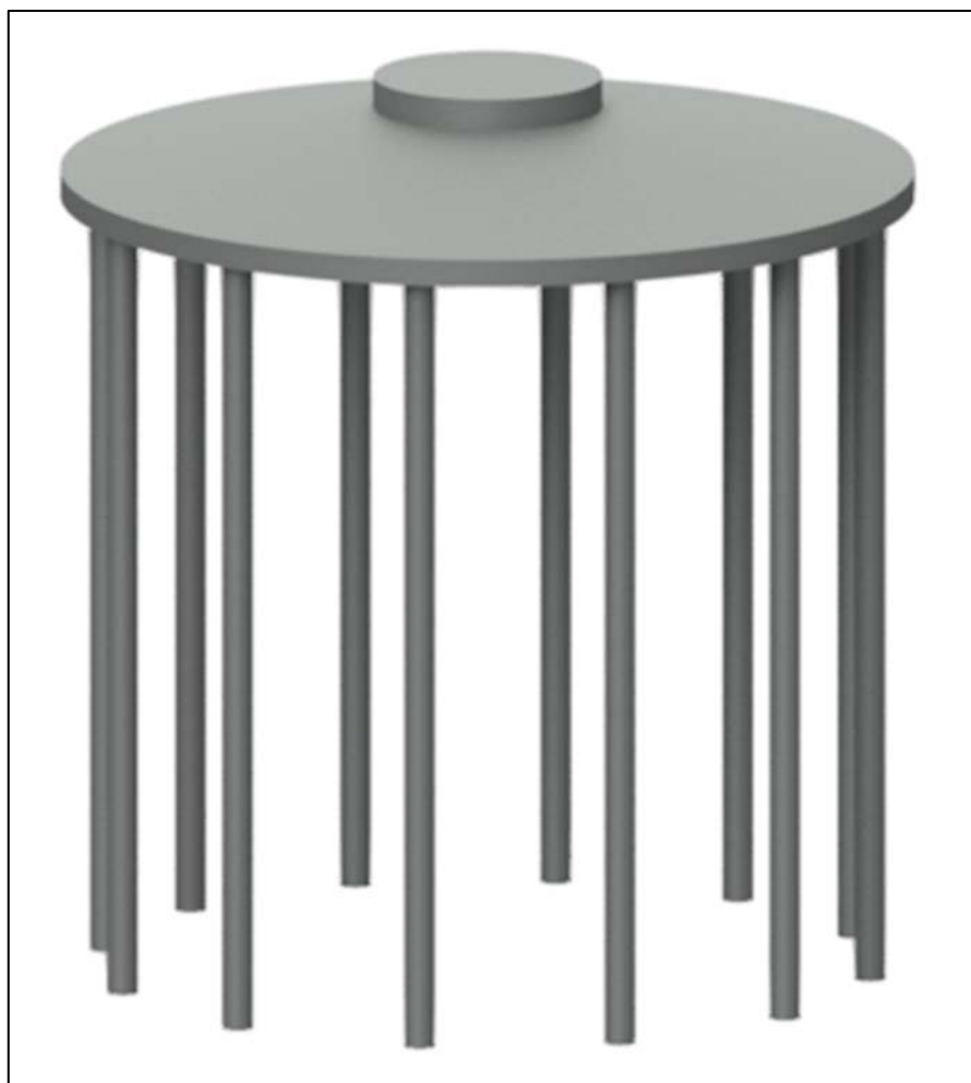
Figura 1: vista tridimensionale della fondazione dell'aerogeneratore
