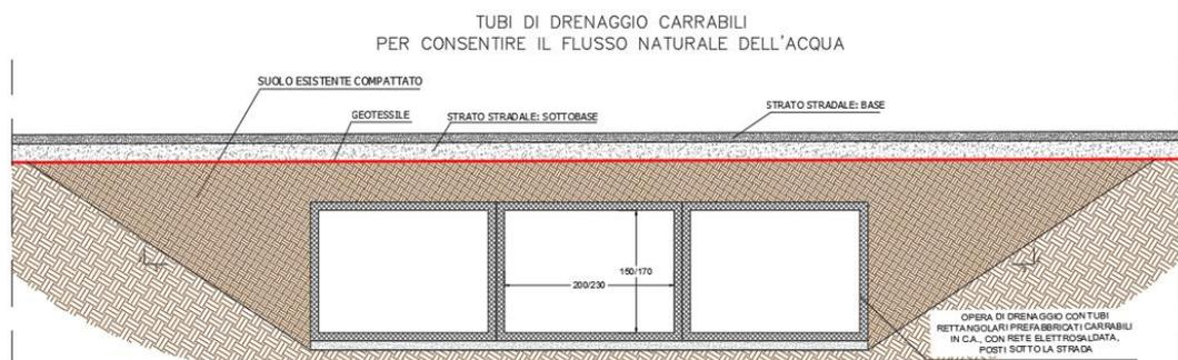
**Figura 65** Porzione sud-est dell'area d'impianto in planimetria ed attraversamento tipo, sotto le strade: sia per la strada a nord che per quella a sud
