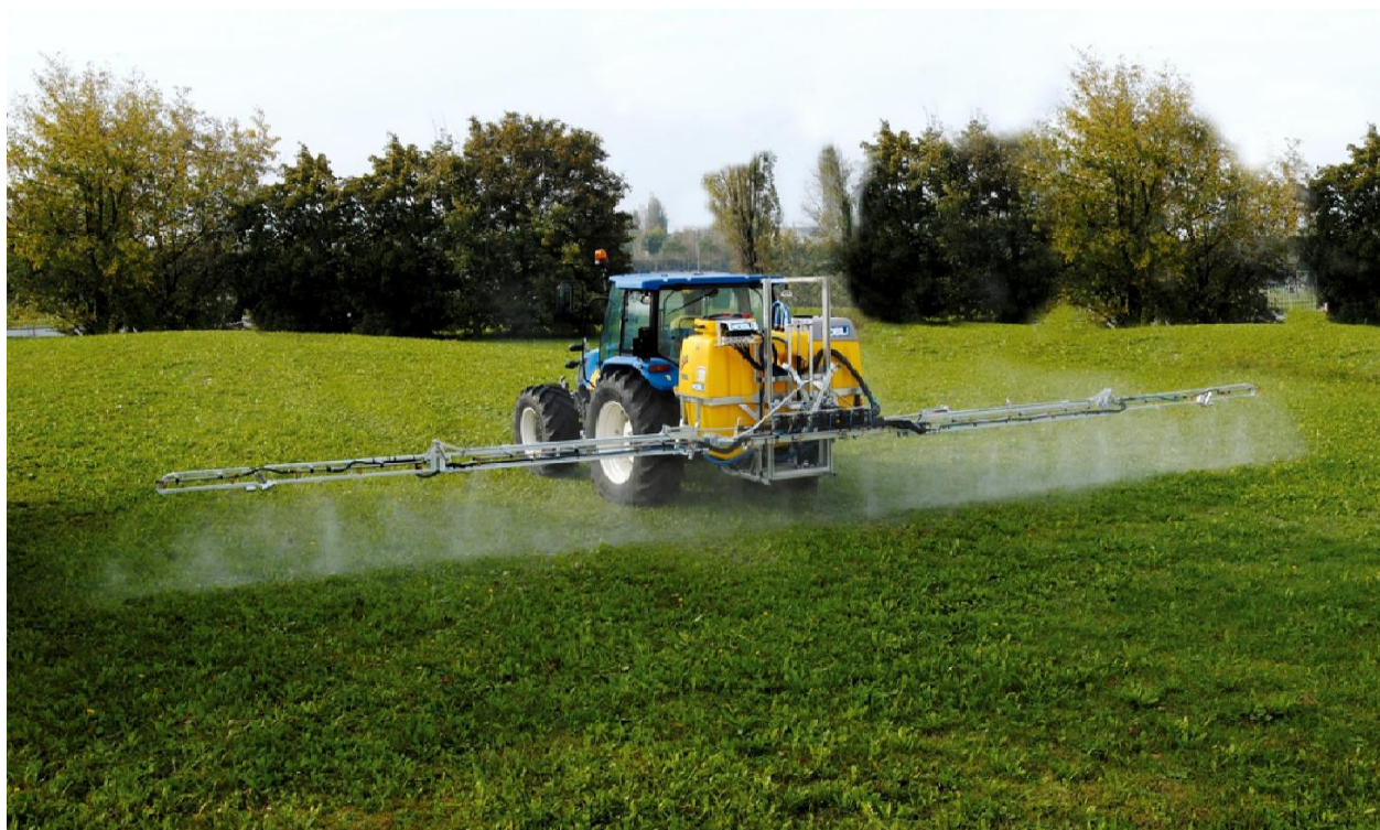
Foto 6: barra irroratrice con ugelli antideriva
