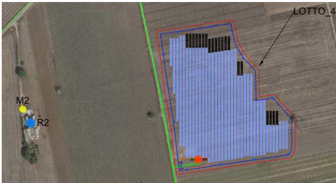
LOTTO_4: Indicazione dei ricettori (pallini azzurri), delle cabine di trasformazione BT/MT (pallini rossi), dei punti di misurazione di Leq(A) (pallini gialli)
