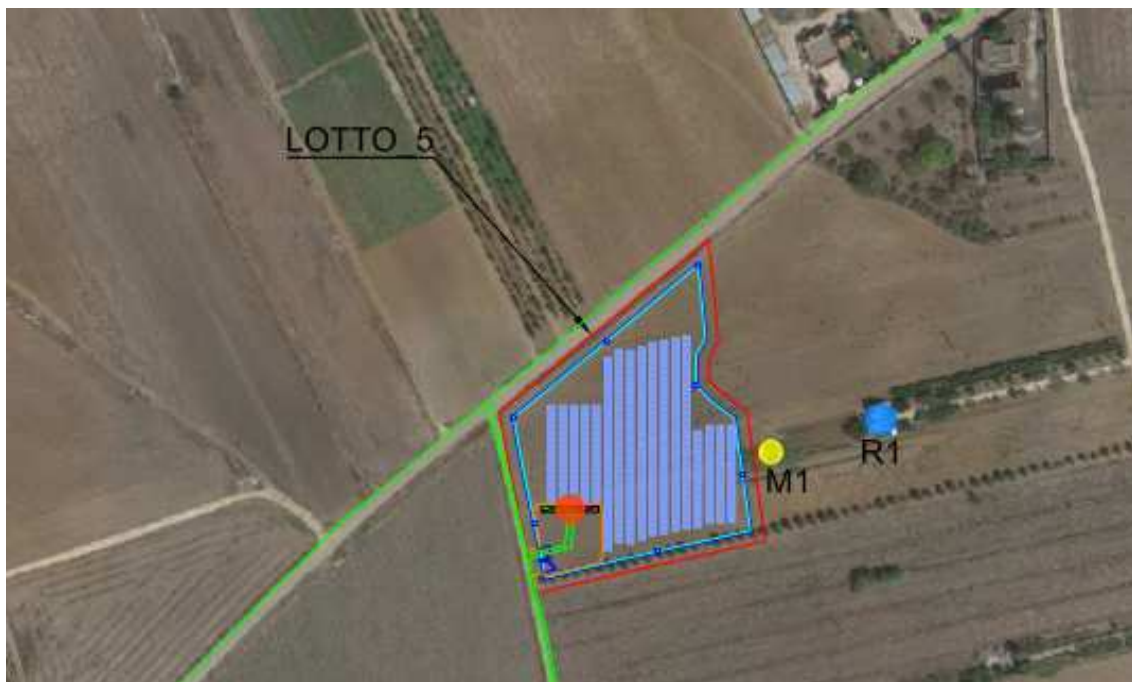
LOTTO_5: Indicazione dei ricettori (pallini azzurri), delle cabine di trasformazione BT/MT (pallini rossi), dei punti di misurazione di Leq(A) (pallini gialli)
