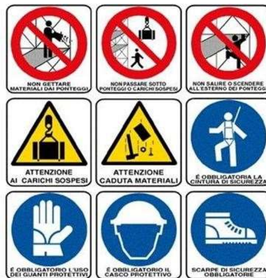
Cartellonistica minima di cantiere
