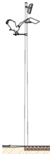
Dettaglio sostegno per videosorveglianza e illuminazione
