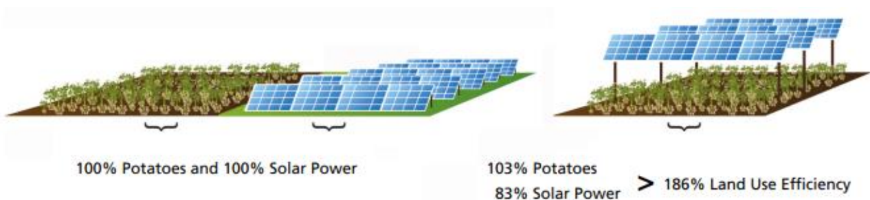
Figura 16: LER rilevato per l'impianto sperimentale di Heggelbach nel 2017 e nel 2018 (Fonte: Trommsdorff M. et al., 2020)
