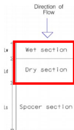
Figura 6.8: modulo tipo descrivente il modello concettuale idrologico dell'installazione di strutture fotovoltaiche a tracker su pari infissi comprendente l'area pannelli (in rosso) e l'area di interfila (Fonte: Hydrologic response of solar farm Cook 2013 American Society of Civil Engineers)
