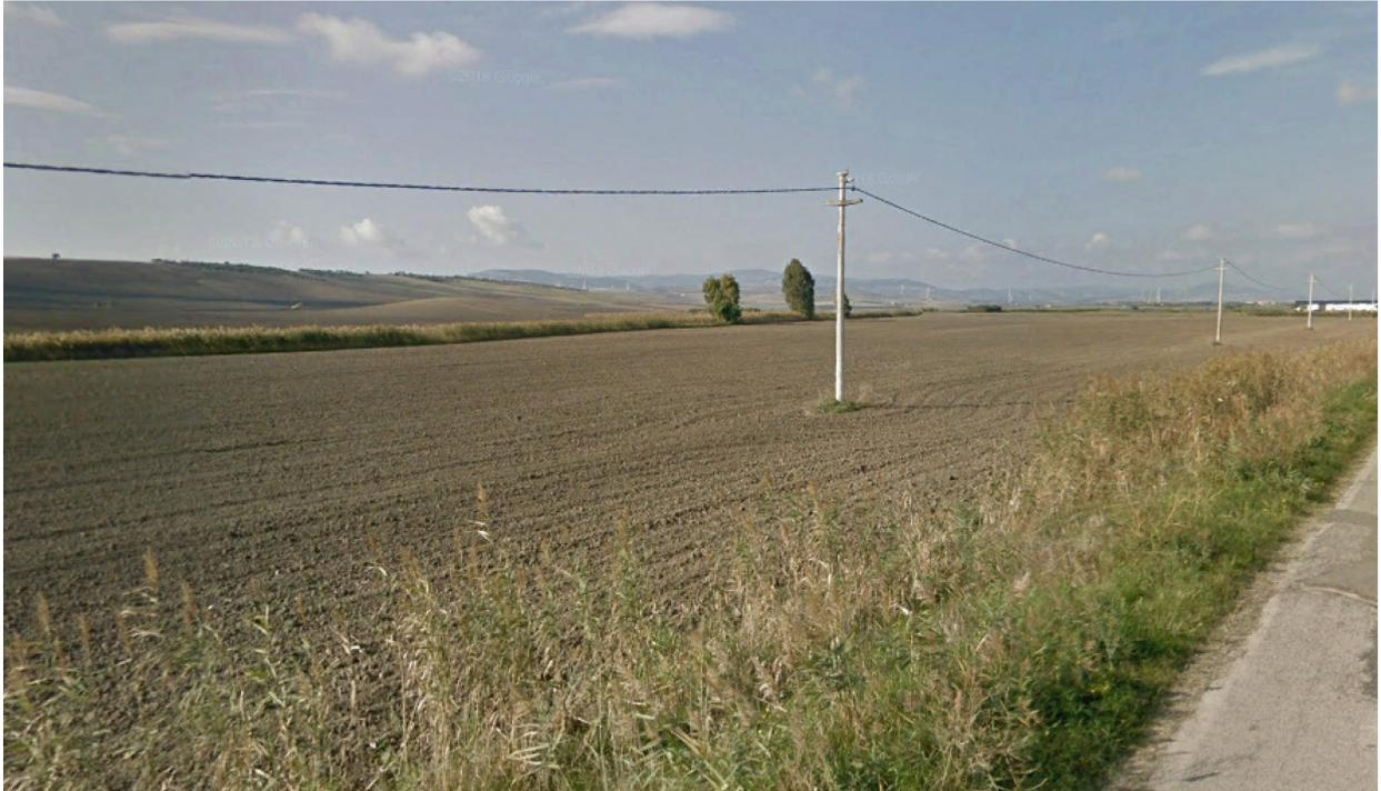
*Figura 2.8: Interferenza ELE05 - Linea elettrica aerea in corrispondenza del punto di attraversamento del cavidotto MT interrato di collegamento tra le sezioni S2 ed S1*
