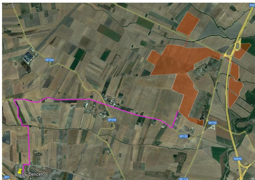
Figura 3.6: In magenta linea di connessione AT dal campo FV alla SE Deliceto
