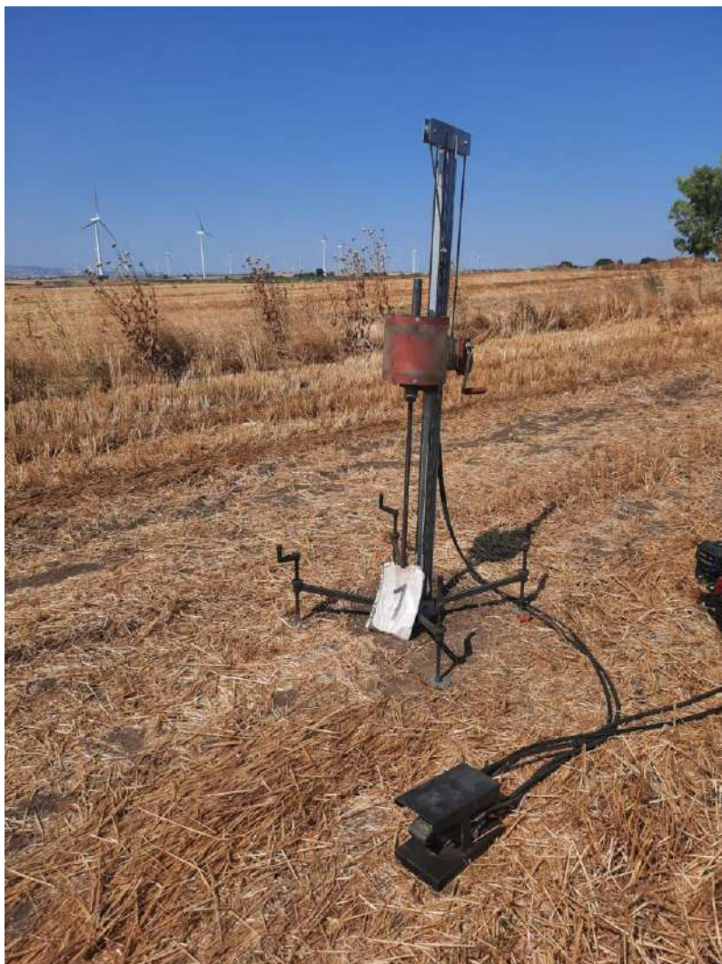
Figura 17 - Realizzazione della prova penetrometrica PPI
