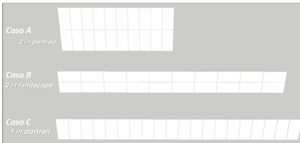
Figura 13. Differenti configurazioni degli inseguitori solari monoassiali
