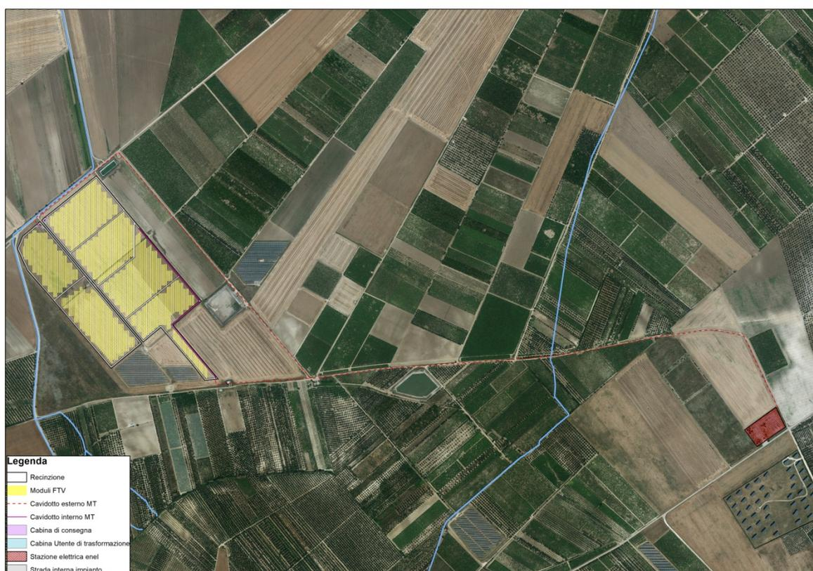
Figura 7: Individuazione interferenze con canali di bonifica
