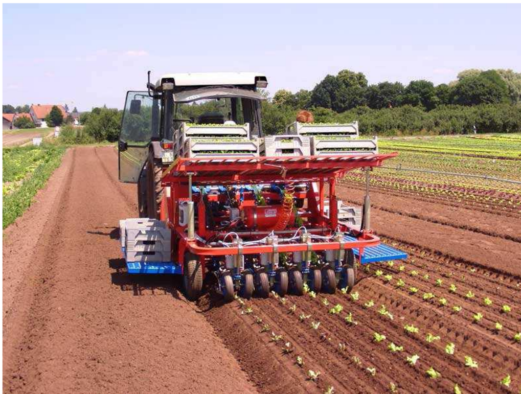
Fig. 6. Macchina trapiantatrice per ortive
