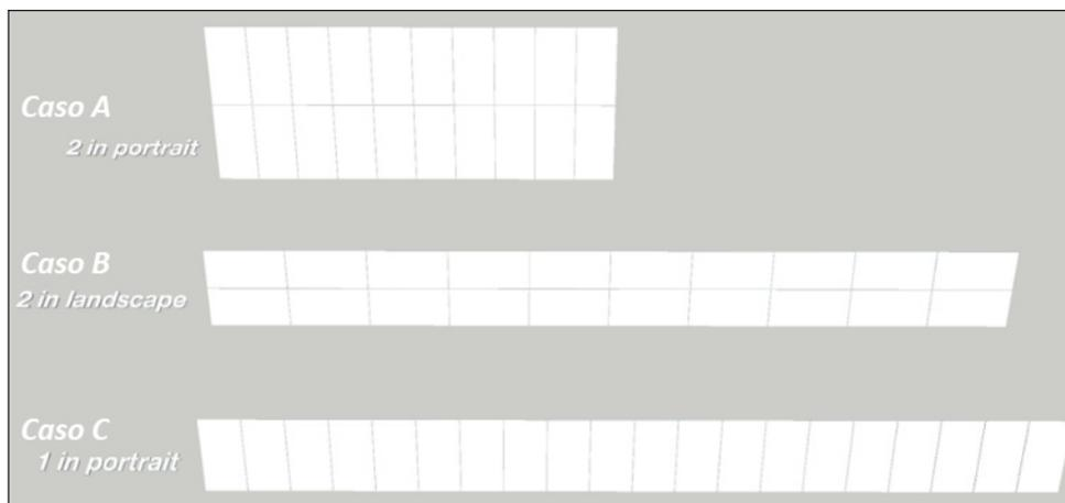
Figura 7 – Differenti configurazioni degli inseguitori solari monoassiali
