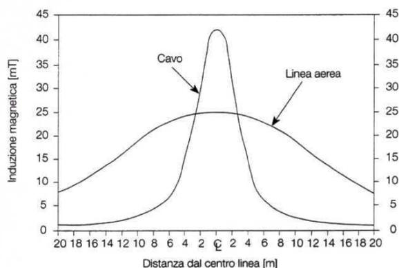
Fig. 13. Induzione magnetica per linea aerea e cavo interrato
