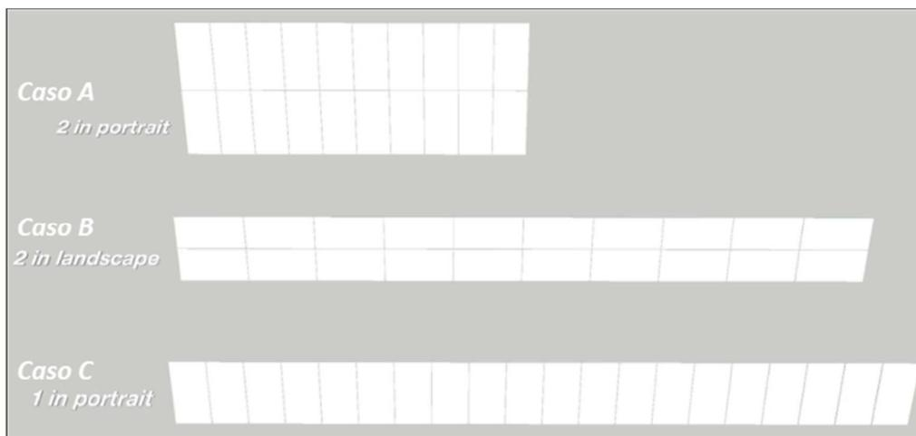
Fig. 5. Differenti configurazioni degli inseguitori solari monoassiali
